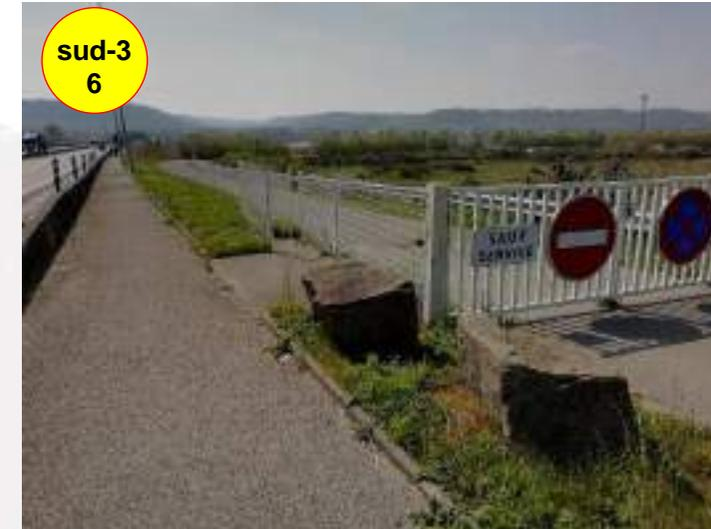
**Solution proposée :** jalonner le trottoir pour piéton et cyclistes, derrière la bordure DBA
